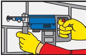
Perforación de orificio con un taladro eléctrico al diámetro y profundidad requeridos. El diámetro del orificio de perforación debe estar de acuerdo con el tamaño del anclaje.
